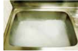
上の写真はシンク内にガス(LPG)が滞留する様子をドライアイスで再現したイメージです。
